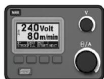
Boutons de réglage de la tension et de la vitesse de dévidage / intensité. Les autres paramètres sont contrôlés par des boutons-poussoirs et du texte affiché à l'écran.
