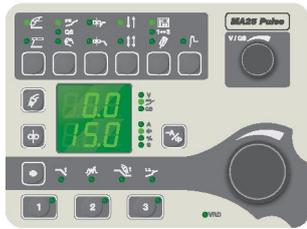
Boutons de réglage de la tension/QSet™ et de la vitesse de dévidage/intensité. Autres réglages à l'aide des boutons-poussoirs.
